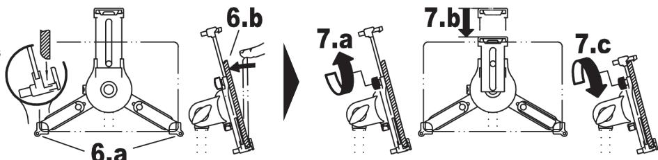
6 a. Tablet in beide Haltecken einlegen...
